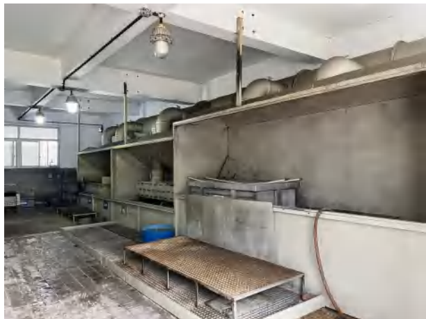
危废库旁-酸洗退镀线（地上槽体/生产线）
