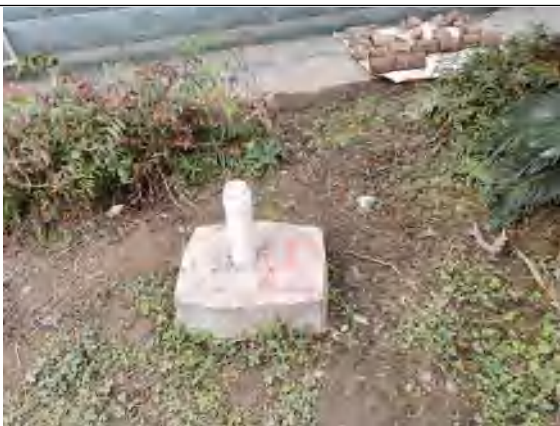
D2监测井（固态原料及成品库东侧，井深12m）
